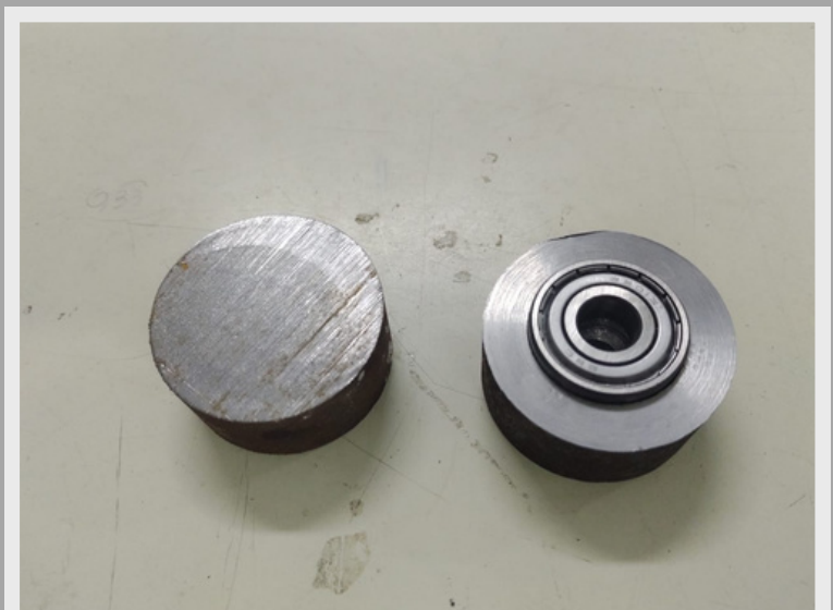
Rodamientos para accionamiento de la cinta.
