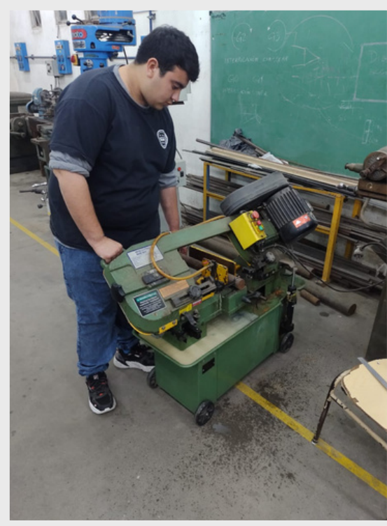
Corte de partes para estructura metálica.
